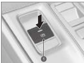
1 Διακόπτης ηλεκτρικού χειρόφρενου
