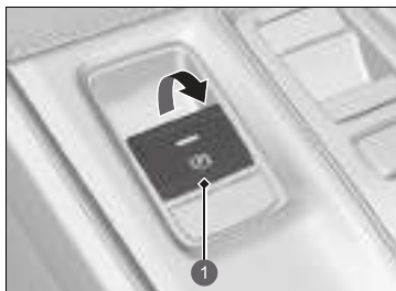
1 Διακόπτης ηλεκτρικού χειρόφρενου
