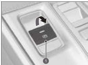
1 Διακόπτης ηλεκτρικού χειρόφρενου
